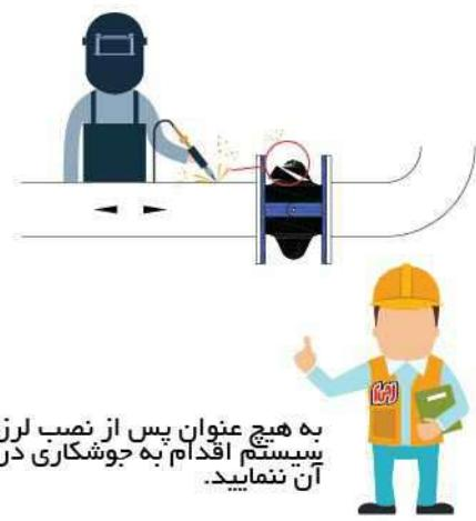
به هیچ عنوان پس از نصب لرزه گیر در سیستم اقدام به جوشکاری در مجاورت آن ننمایید.
