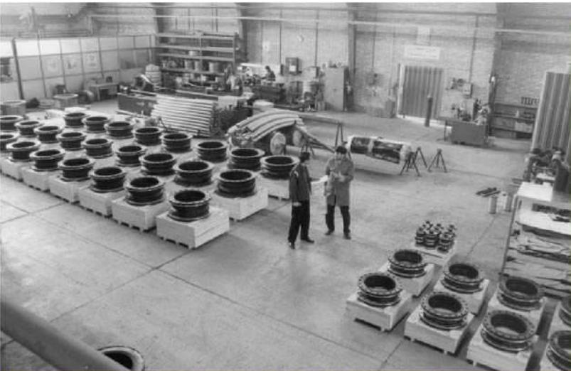
امکان سوراخکاری اتصالات فوق مطابق انواع استانداردهای BS, ANSI, DIN, ISO و... وجود دارد. علاوه بر ابعاد ذکر شده امکان تولید لرزه گیرهای فوق در ابعاد بزرگتر از ۶۰ اینچ و کوچکتر از ۱۰ اینچ نیز وجود دارد. لرزه گیرهای فوق در انواع یک قوس، دو قوس و... و در طول های مختلف تولید می گردند.
